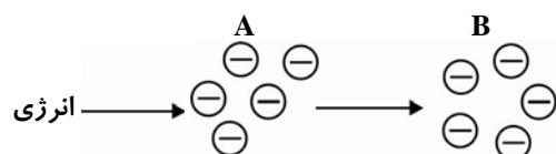
○ نکته: حرکت الکترون‌های آزاد در درون سیم به صورت ضربه‌ای است و سرعت این ضربه‌ها در حدود سرعت نور است.
