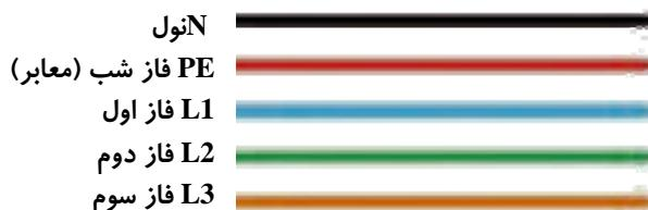
○نکته: جهت مصارف خانگی و تجاری، نیاز به کابل دو سیمه است. (یک سیم فاز و یک سیم نول)
